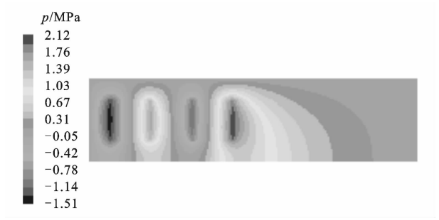
图 6 Fluent 计算的压力分布
